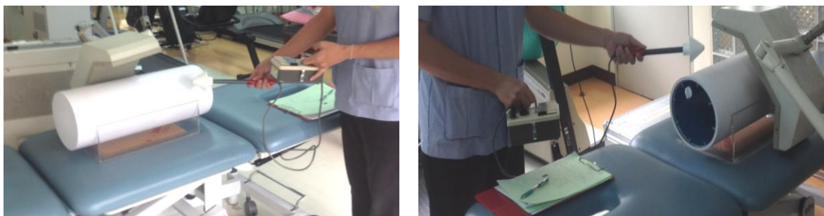
ภาพที่ 2 แสดงการวัดความเข้มของคลื่นแม่เหล็กไฟฟ้าจากเครื่อง Microwave Diathermy
