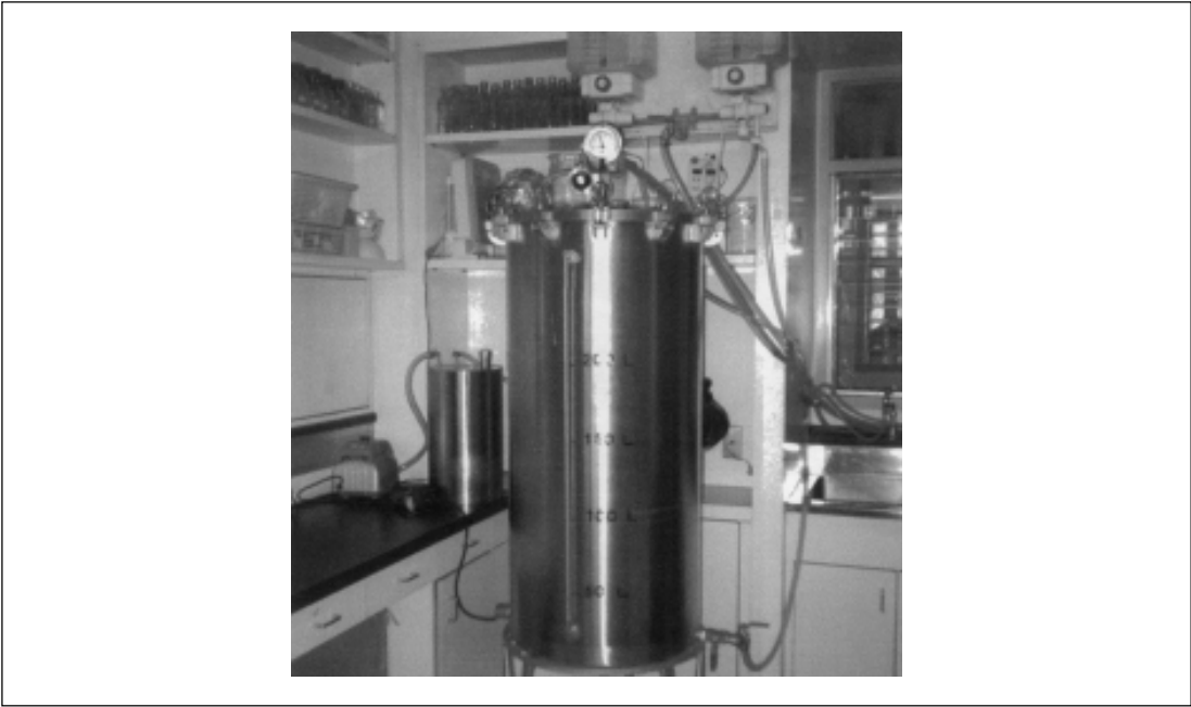
รูปที่ 2 ถังหมัก (Fermenter) ขนาดบรรจุ 200 ลิตร ที่พัฒนาขึ้นพร้อมอุปกรณ์ต่าง ๆ
